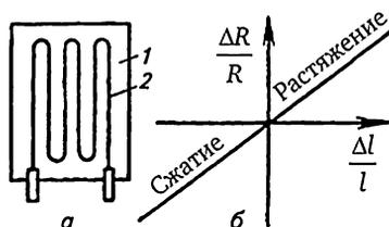
Рис. 2.8. Тензометрический датчик (а) и его характеристика (б)
