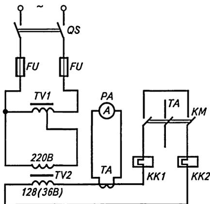
Рис. 9.4. Схема испытания теплового реле:
