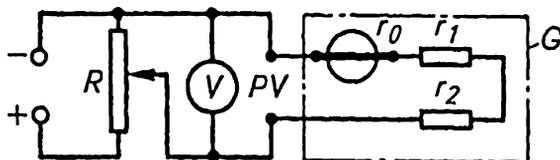
Рис. 21.6. Схема подгонки сопротивления цепи рамки:
