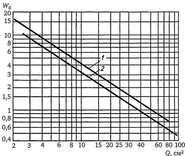
Рис. 19.1. График для определения числа витков катушки
