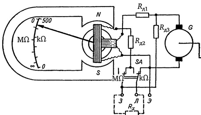
Рис. 2.6. Мегаомметр
