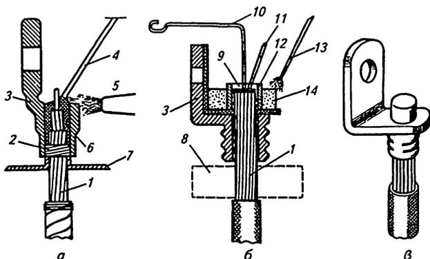
Рис. 17.3. Оконцевание алюминиевых жил кабеля:
