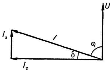
Рис. 2.16. Векторная диаграмма токов в изоляции
