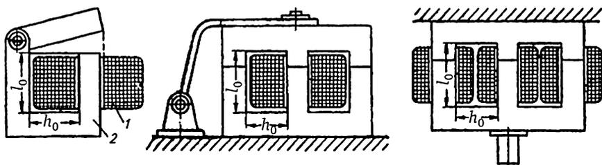
Рис. 19.3. Типы магнитопроводов аппаратов переменного тока:
