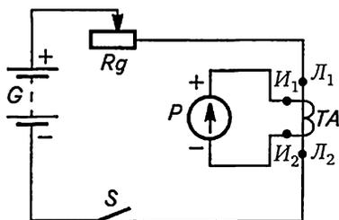
**Рис. 8.4. Схема определения полярности выводов трансформатора тока ТА:**
