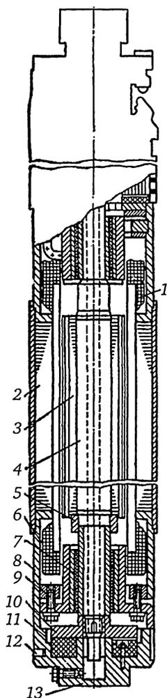
**Рис. 5.5. Погружной электронасос:**
