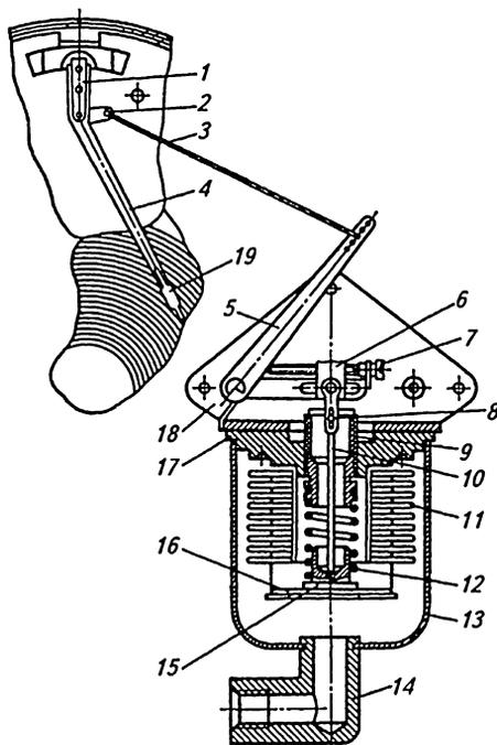
*Рис. 21.10. Самопишущий сильфонный манометр МСС:*
