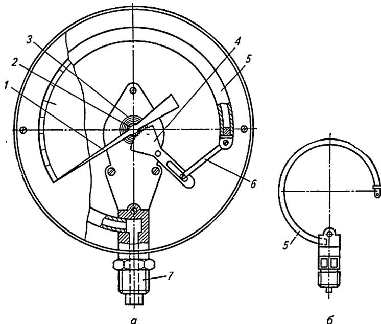
**Рис. 21.11. Пружинный манометр:**
