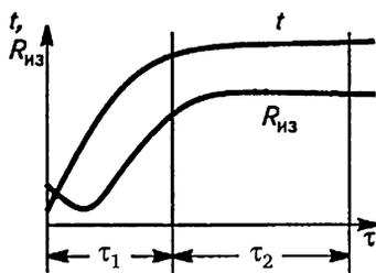
Рис. 5.2. Зависимость температуры  $t$  и сопротивления изоляции  $R_{из}$  обмоток электродвигателя от времени  $\tau$  при сушке
