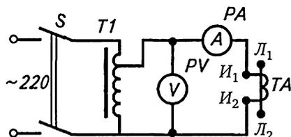
**Рис. 8.5. Принципиальная схема снятия характеристики намагничивания трансформатора тока:**
