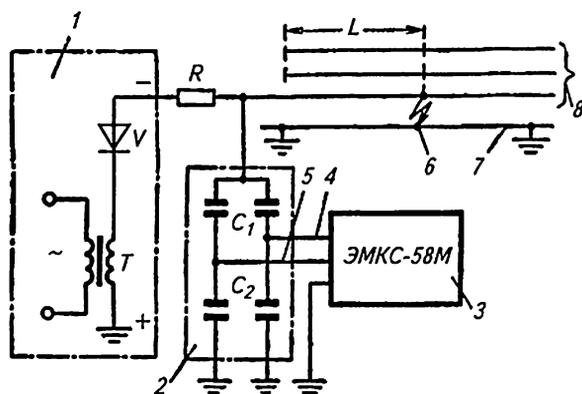
Рис. 17.5. Схема определения места повреждения методом колебательного разряда: 1 — высоковольтная испытательная установка; 2 — делитель напряжения; 3 — прибор; 4 — цепь пуска; 5 — цепь останова; 6 — место повреждения; 7 — свинцовая оболочка; 8 — жилы кабеля;  $L$  — расстояние до места повреждения
