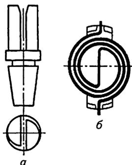
**Рис. 21.1. Форма оправки для навивки спиральных пружин:**
