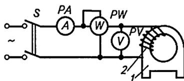
Рис. 5.4. Схема сушки обмоток электрических машин потерями в стали:
