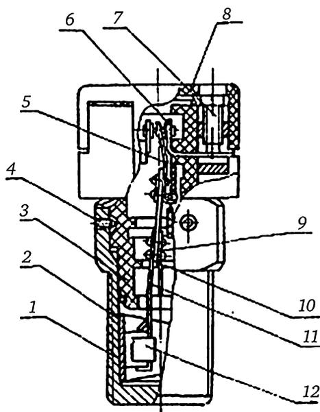
Рис. 21.13. Температурное реле ТРМ-11:
