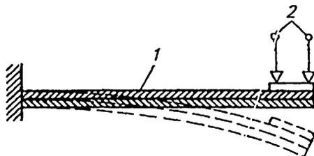
Рис. 2.10. Биметаллический датчик температуры
