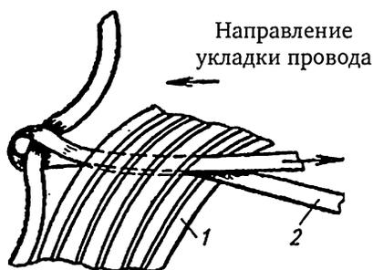
Рис. 16.3. Схема бандажирования катушки трансформатора:
