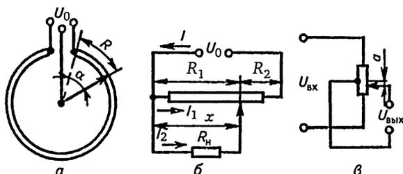
Рис. 2.7. Потенциометрические датчики:
