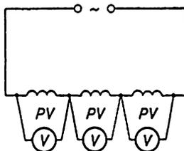
**Рис. 5.1. Соединение фаз трехфазного электродвигателя в открытый треугольник**
