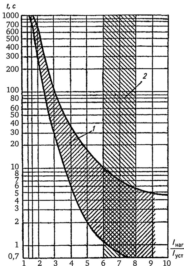
Рис. 9.2. Защитные характеристики автоматических выключателей АП50:
