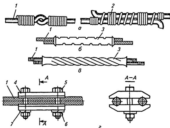
Рис. 17.2. Соединение голых проводов воздушных линий:
