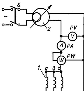
Рис. 5.3. Схема токовой сушки обмоток электрических машин:
