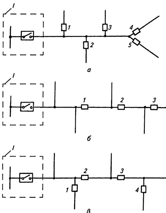
Рис. 14.4. Схемы сети с автоматическим секционированием:
