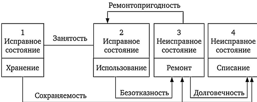
Рис. 4.1. Модель состояния оборудования
