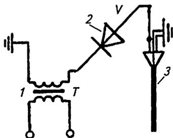
Рис. 7.3. Принципиальная схема испытания кабеля:
