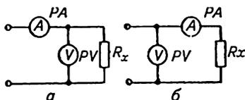
Рис. 2.5. Схемы измерения сопротивлений:
