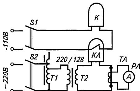
Рис. 8.6. Принципиальная схема испытания реле тока:
