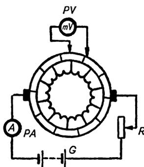
**Рис. 5.6. Определение места замыкания между ламелями методом милливольтметра**
