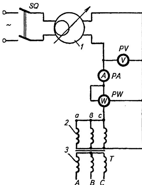
Рис. 6.2. Схема сушки трансформатора токами нулевой последовательности:
