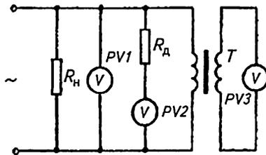
Рис. 2.1. Способы измерения напряжения вольтметрами, включенными:
