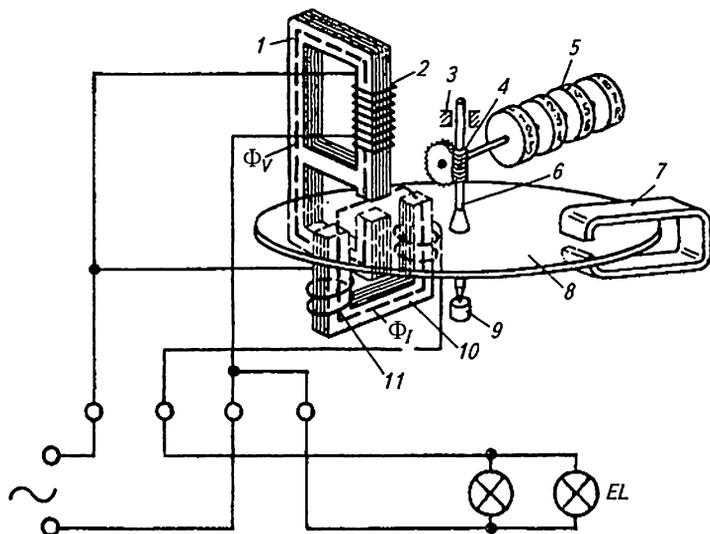
**Рис. 2.3. Однофазный индукционный счетчик:**
