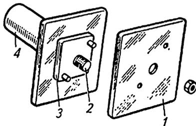
Рис. 21.4. Оправка для намотки бескаркасных рамок:
