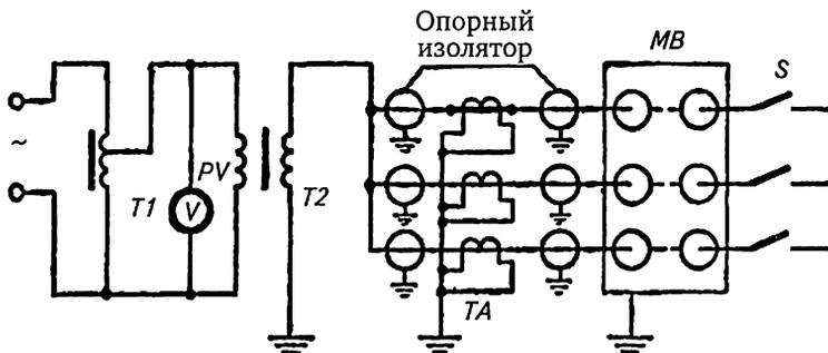
Рис. 8.1. Принципиальная схема испытания изоляции ячейки КРУ:
