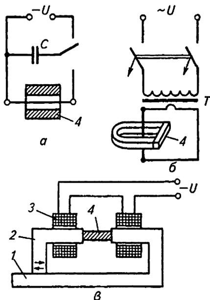
Рис. 21.5. Схемы для намагничивания постоянных магнитов:
