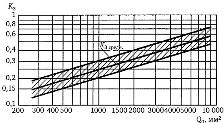
Рис. 19.2. График для определения коэффициента заполнения  $K_3$
