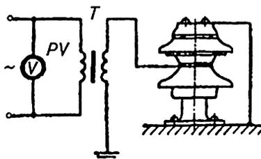
Рис. 8.2. Принципиальная схема испытания опорного изолятора повышенным напряжением
