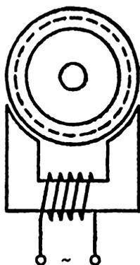
**Рис. 5.8. Определение места межвитковых замыканий в обмотках якорей при помощи электромагнита и стальной пластинки**
