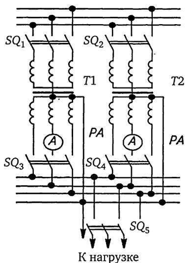
Рис. 6.3. Принципиальная схема параллельной работы двух трансформаторов:  $T1$  и  $T2$  — трансформаторы;  $SQ_1, \dots, SQ_5$  — выключатели
