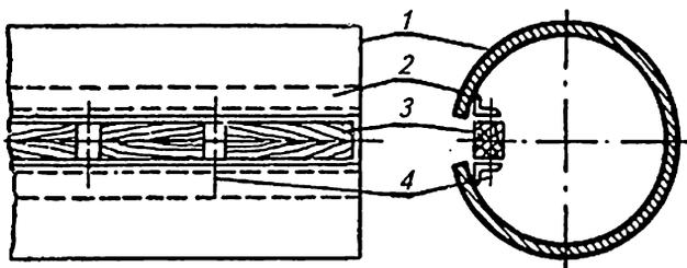
Рис. 16.1. Универсальный шаблон для намотки катушек трансформаторов:
