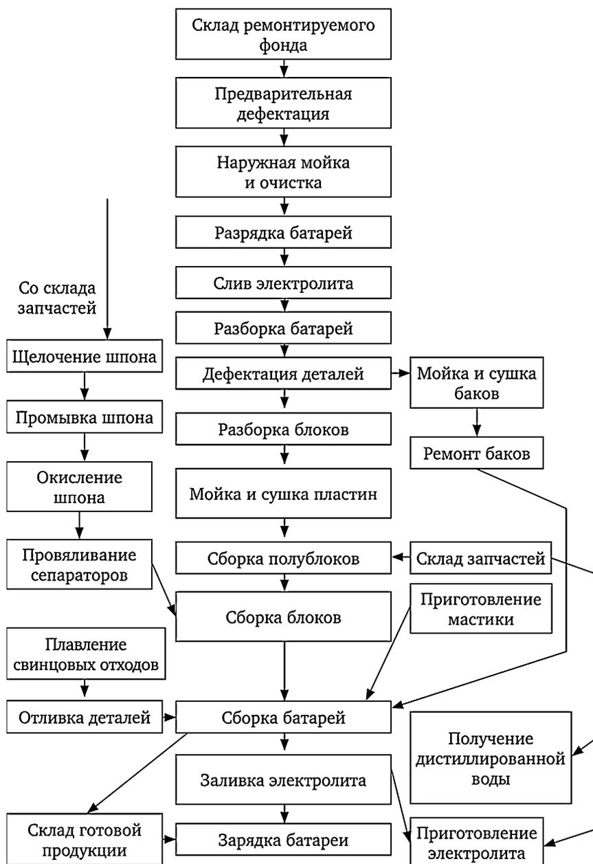
Рис. 23.5. Технологическая схема ремонта стартерных аккумуляторных батарей
