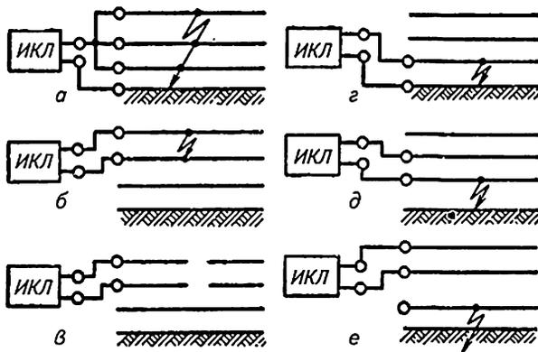
Рис. 17.4. Присоединение прибора для испытания кабельных линий к линии при различных случаях повреждений:
