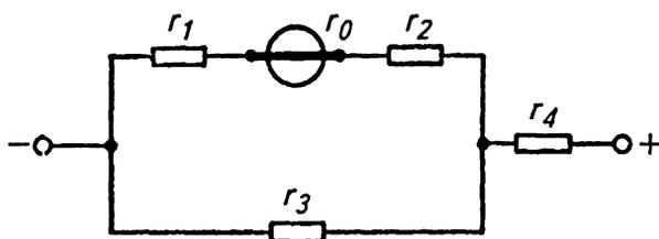
Рис. 21.7. Схема компенсации температурной погрешности магнитоэлектрического прибора:
