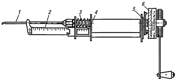
Рис. 7.1. Прибор для измерения глубины загнивания древесины при помощи буравчика: 1 — буравчик; 2 — рейки со шкалой; 3, 5 — пружины; 4, 6 — шкалы
