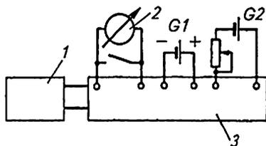
Рис. 21.8. Схема проверки исправности измерительной схемы автоматических потенциометров:
