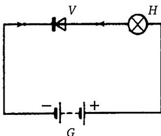
Рис. 23.1. Схема проверки диода:
