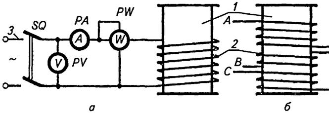
Рис. 6.1. Схема сушки трансформатора при помощи намагничивающей обмотки:
